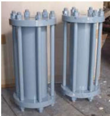
**Рис 7. Фильтры рассчитанные на давление 100 атм и производительность 6 атм**
